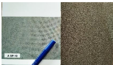
Gambar 2. material hasil blasting check menggunakan SSPC Vis-1
