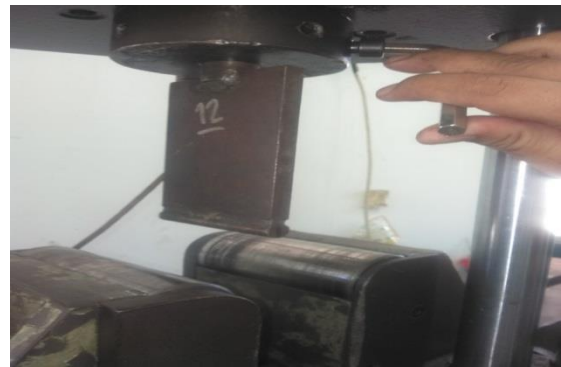
Gambar 2.1 pemasangan mandril pada mesin bending
