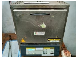
Gambar 4(a). Pemanasan specimen pada furnace
