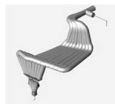
Gambar 5(a). Mode shape pada 13,443 Hz (Modal analisis di CAESAR II 2014)
