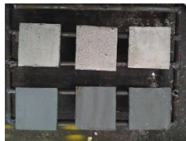
Gambar 4(b). Specimen setelah dipanaskan di dalam furnace
