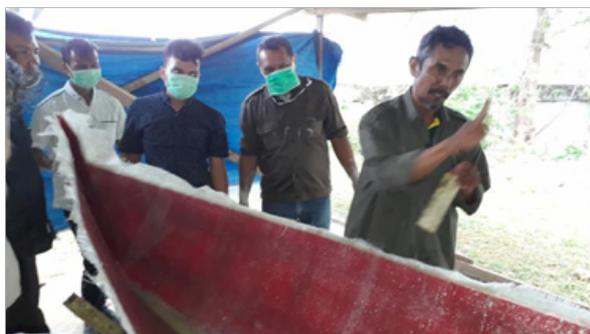
Gambar 9. Proses pengeringan resin perahu fiberglass dalam cetakan
