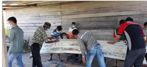
Gambar 3. Proses penghalusan permukaan perahu
