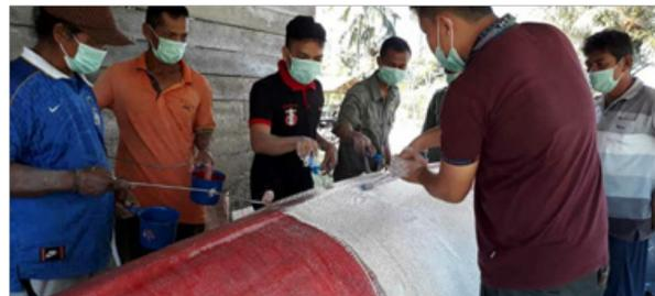
Gambar 4. Pembuatan mal perahu fiber
