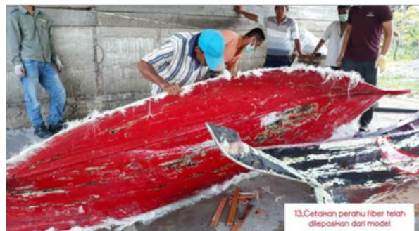
Gambar 6. Proses pelepasan mal dari model
