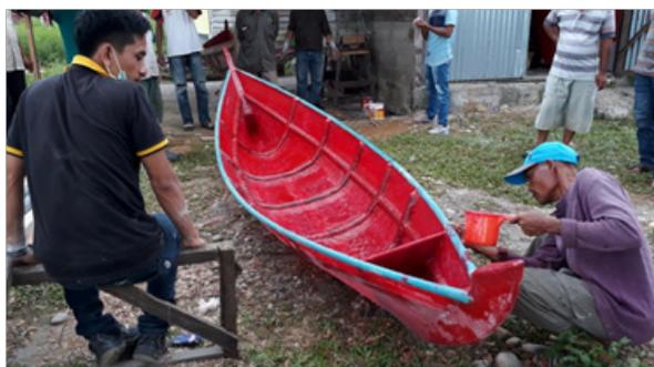
Gambar 10. Perahu fiberglass yang sudah diberikan tulangan
