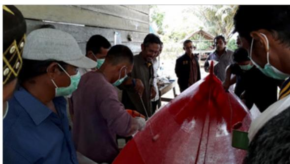
Gambar 8. Pemasangan fiberglass dan pemolesan resin pada cetakan
