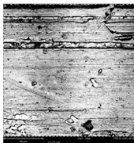
Gambar 8. Hasil pengujian mikro spesimen yang tidak mengalami korosi
