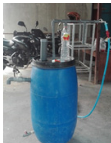
Gambar 8. Biodigester Portable Sumber : Dokumentasi Pelaksanaan, 2018
