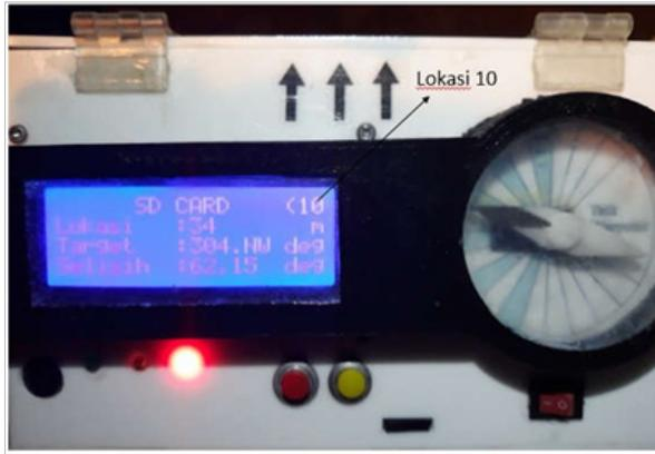
Gambar 6. Tampilan Perangkat dalam Menentukan dan Mengukur Jarak dan Sudut Target.
