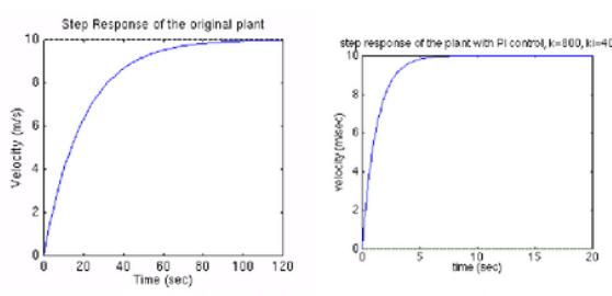
Gambar 4. Hasil pengujian cruise control
