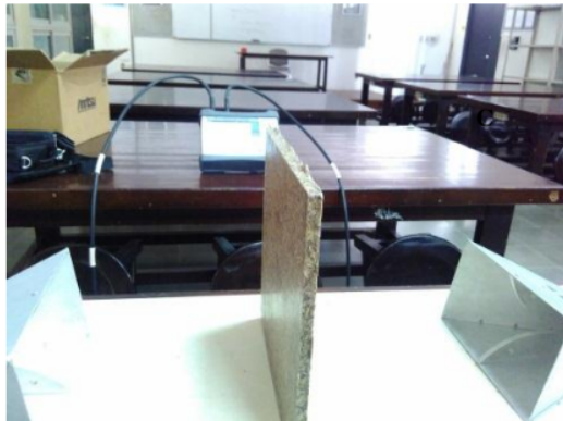
Gambar 7. Pengukuran Reflection loss dan Return Loss
