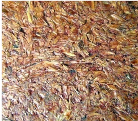
Gambar 4. Partikel board sekam
